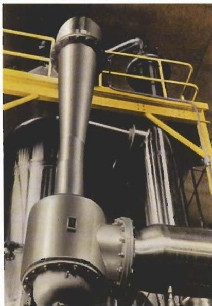
这是一台三效降膜乳制品蒸发器，每天生产568立方米炼乳。在一效和二效之间的热力压缩机降低了蒸汽耗量，因而蒸发器的传热面积和用水量都可以减少。
