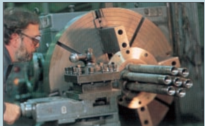
Abaixo: Torno de 32", utilizado para o perfeito alinhamento do suporte dos bicos.
