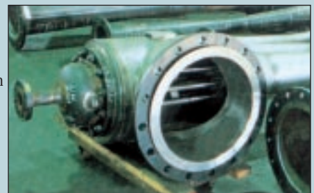
Acima: Vista de um cabeçote com múltiplos bicos.
